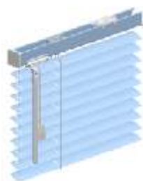
Működtetés húzószinórral, lamellák billentése külön karral
