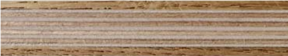
Laubholz mit Sperrholz-Mittellage
