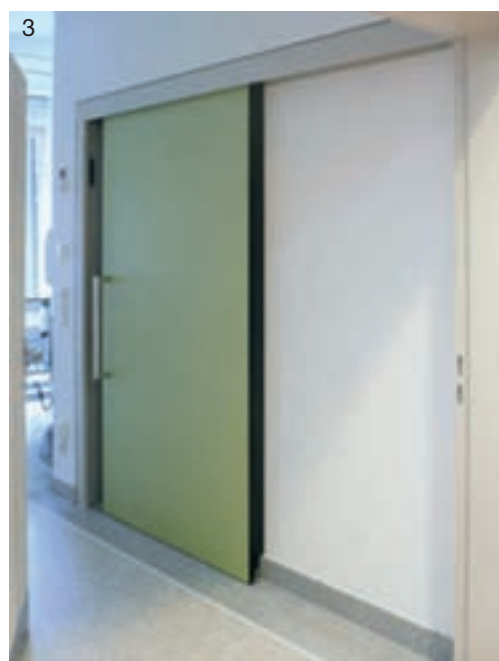
1 T90-SD 42 Tür mit verdeckten Beschlägen, Stahlzarge, ITS und weißer Schichtstoffoberfläche. Rechts daneben T30 Tür in gleicher Grundausstattung als Superformat-Drehflügeltür mit durchgehender Flügelbreite von 1.650 mm. 2, 3, rechts: Großformatige T30/RS Schiebetüren mit Spezialaufwerk und Edelstahl-Spezialbeschlägen. Die Oberflächen in strapazierfähigem HPL sind passend zu den Wänden in RAL-Farben lackiert.
