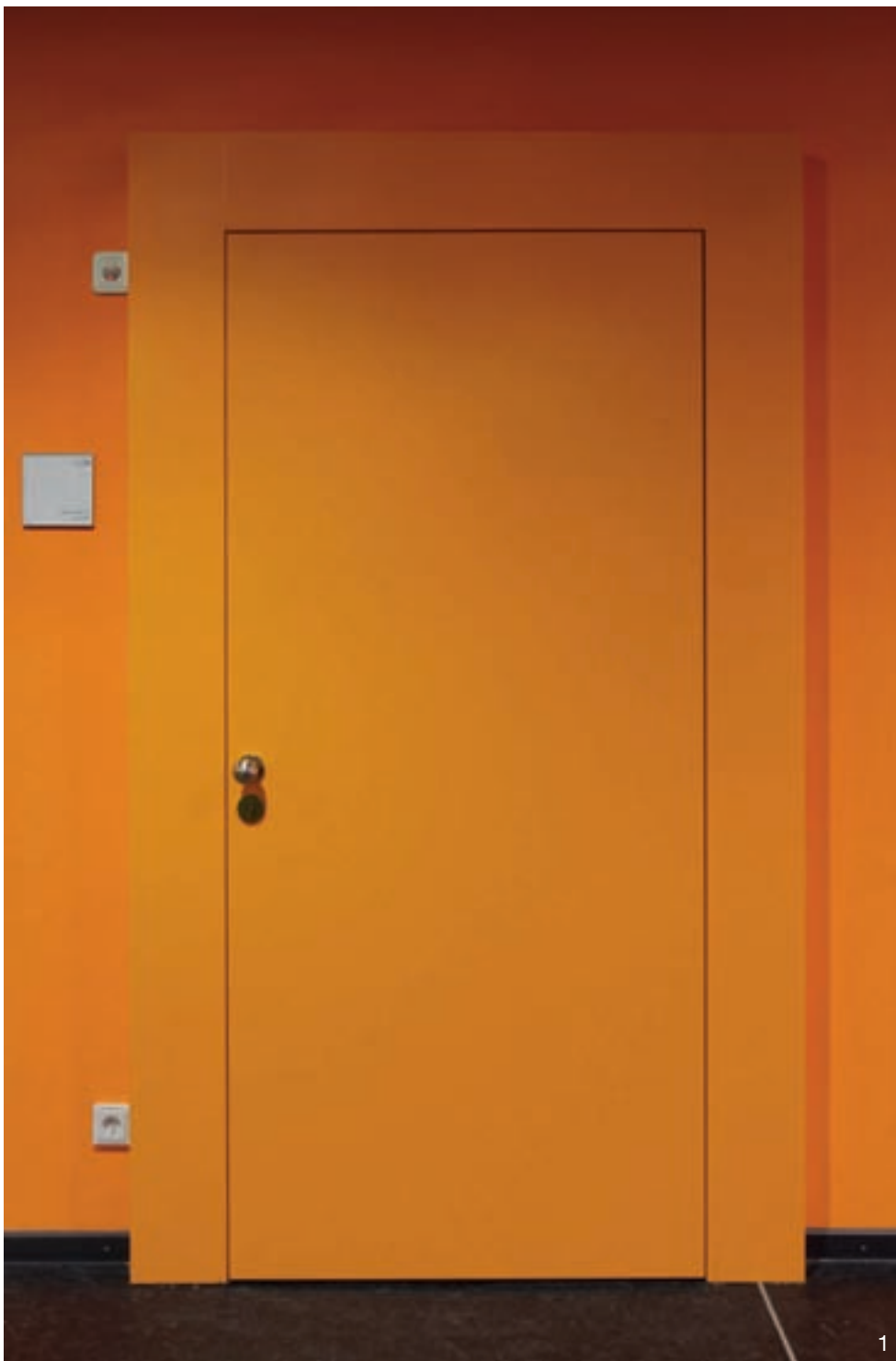
1 Die orange Schallschutztür 50 dB Rw,P ist in einer Spezialfaltstockzarge vor die Wand gesetzt, Bänder und Schließer sind verdeckt. 2 Wandflächenbündige T30/RS Nischentüren mit verdeckten Bändern und Schließern, NCS-Lackierung in gelb und orange. 3 T90/RS Tür in einer Holz-Spezialzarge mit Schallschutz 37 dB Rw,P und verdecktem Schließer, lackiert in NCS S 1060-R 30 B Pink.
